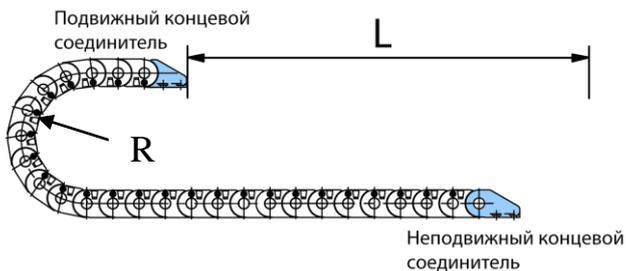
Рис. 2 Способ крепления концевых соединителей:
