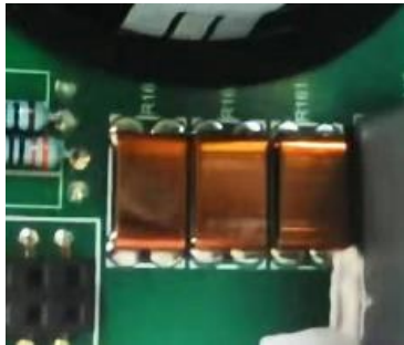
Шунт в цепи постоянного тока
