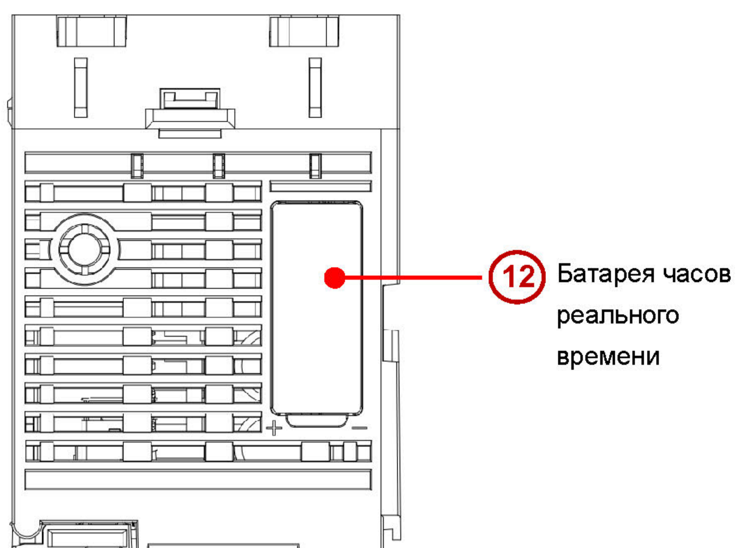
Рис. 6 Описание элементов задней панели HCQ0-1200-D
