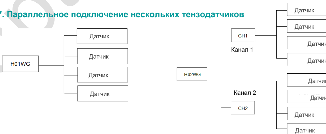
проводное подключение датчика
