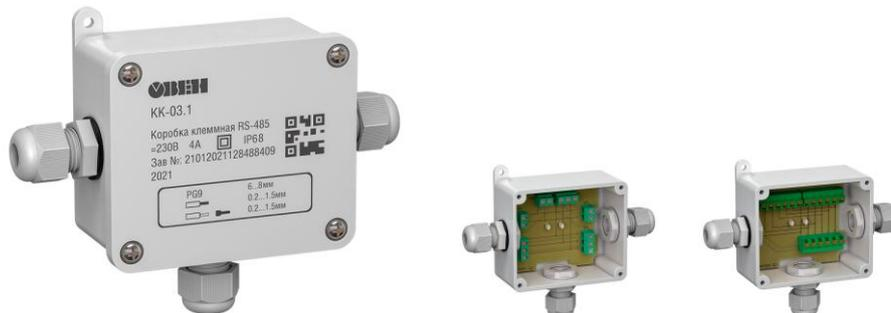
КК-03 предназначена для разветвления кабелей интерфейса RS-485, а также сетей 230 В с номинальными токами не более 4 А на предприятиях различных отраслей промышленности и сельского хозяйства. Разветвитель интерфейса изготавливается в герметичном корпусе со степенью защиты IP68 согласно ГОСТ 14254.
