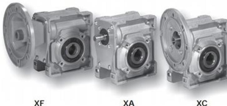
Червячный одноступенчатый мотор-редуктор TRAMEC серии XC является модернизированной серией, изготавливаемой с использованием технологии литья под давлением. Комплектуется электродвигателями мощностью от 0,09 кВт до 11 кВт с крутящим моментом от 4 Нм до 800 Нм и передаточным отношением от 7,5:1 до 100:1.
