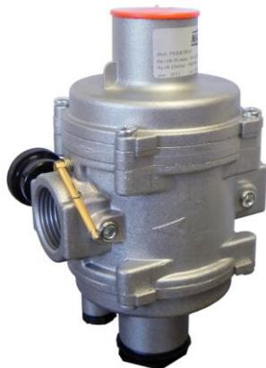
Регулятор FRG/2MB «Компакт-2» представляет собой комбинированный регулятор давления с двойной фильтрацией и оснащенный предохранительно-сбросным клапаном, предохранительно-запорным клапаном, а также штуцерами для отбора давления.
