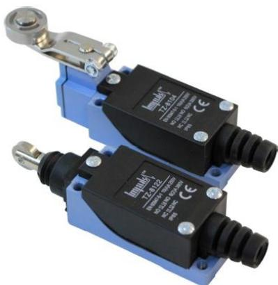
Концевые (конечные) выключатели предназначены для индикации положений контролируемых объектов путем контактной коммутации цепей постоянного и переменного тока при внешнем воздействии на штоки, ролики, кнопки или другие фиксирующие элементы датчика. Концевые выключатели широко применяются в системах управления, контроля и автоматики.
