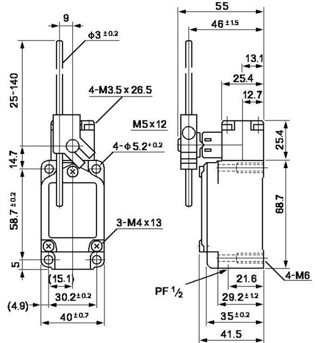
Концевые (конечные) выключатели серии CWLD1 - шток с вертикальным роликом нажимной
