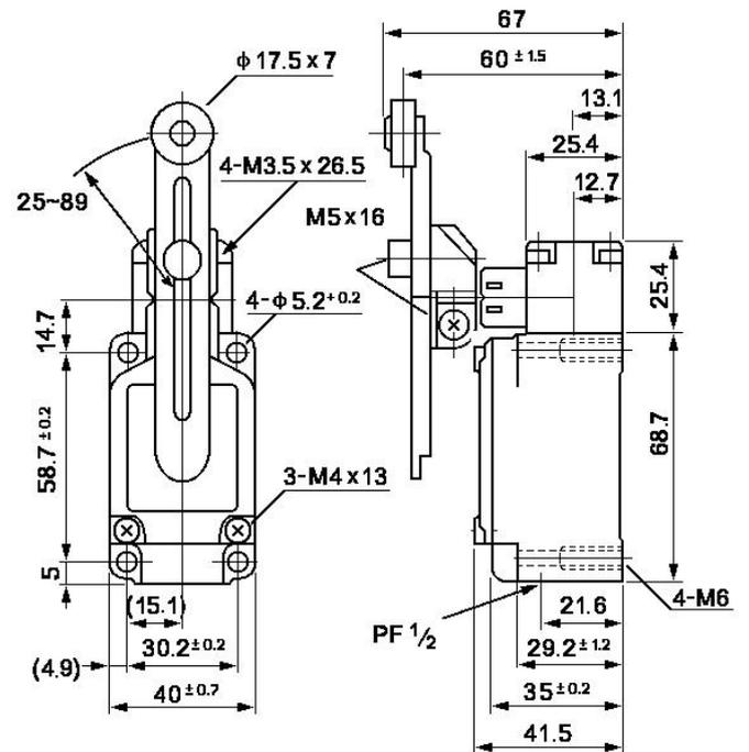
Концевые (конечные) выключатели серии CWLCA32-41 - двойной рычаг с роликами
