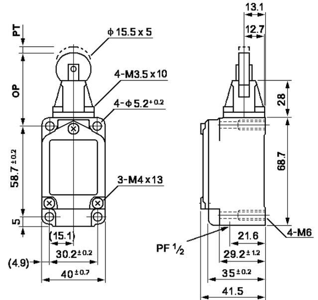
Концевые (конечные) выключатели серии CWLD3 - шток с подшипником нажимной
