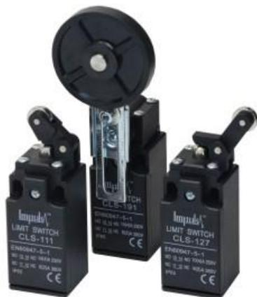
Концевые (конечные) выключатели предназначены для индикации положений контролируемых объектов путем контактной коммутации цепей постоянного и переменного тока при внешнем воздействии на штоки, ролики, кнопки или другие фиксирующие элементы датчика. Концевые выключатели широко применяются в системах управления, контроля и автоматики.
