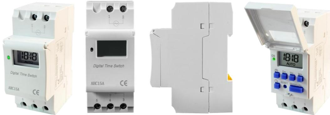
Прибор для автоматического включения/выключения электротехнического оборудования через заданный промежуток времени в течение суток с возможностью привязки выполнения команды к дням недели. Реле имеет один переключающий контакт.
