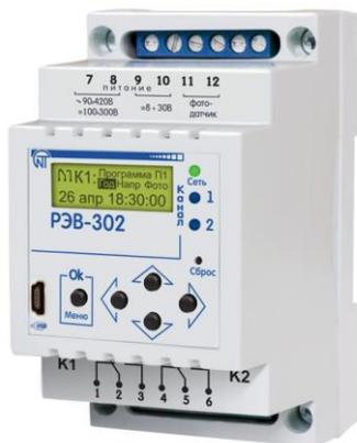
Многофункциональное реле РЭВ-302 представляет собой микропроцессорное программируемое устройство и предназначено для включения/отключения одной или двух нагрузок в предварительно установленные пользователем моменты времени с учетом сетевого напряжения и освещенности внешнего фотодатчика.
