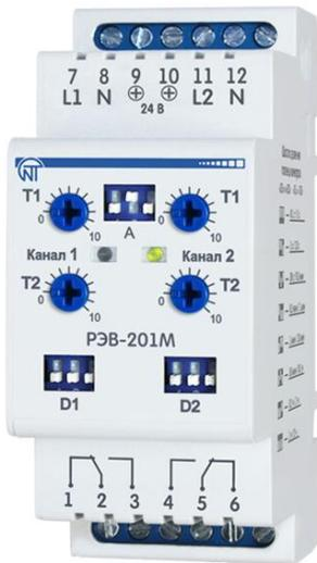
Реле времени электронное двухканальное с задержкой на включение и отключение РЭВ-201М предназначено для коммутации электрических цепей переменного тока 220В/50Гц и постоянного тока 24-100В с регулируемой задержкой времени включения от 0 до 36000с.
