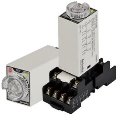
Миниатюрные аналоговые таймеры серии АТМ с компактным малогабаритным корпусом (Ш 21,5 мм х В 28 мм) и простыми 14-контактными штепсельными розетками. Серия АТМ доступна с 11 различными временными диапазонами (от 0,1 сек. до 3 часов) и различными вариантами подачи питания. Таймеры имеют четырехполюсные двухпозиционные контакты, быстрое время сброса 100 мс, стабильность и повторяемость характеристик  $\pm 5\%$  для высокоточного контроля синхронизации.
