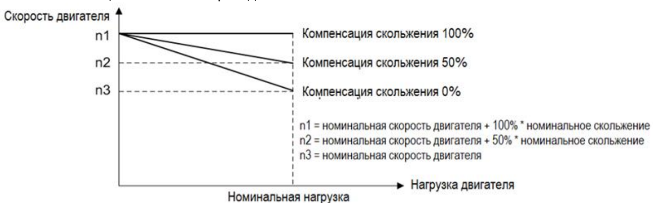
Компенсация скольжения в режиме вращения двигателя
