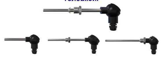
Предназначены для температурных измерений твердых, жидких и газообразных сред. Позволяют проводить измерения достаточно высоких температур – до 900 °C. Присоединение термопар xx5 к измерительной линии производится термопарным кабелем (кабель в комплекте не поставляется, заказывается отдельно).
