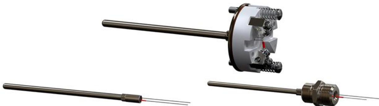
Бескорпусные термопары на основе КТМС (термопарные вставки) модификации 041...101 служат для измерения жидких, твердых и газообразных сред, не агрессивных к оболочке датчика. Модели 061...101 могут работать как в качестве самостоятельных датчиков температуры, так и служить вставками в высокотемпературные модульные термопары ДТПХхх5 (мод. 125...165, 225).
