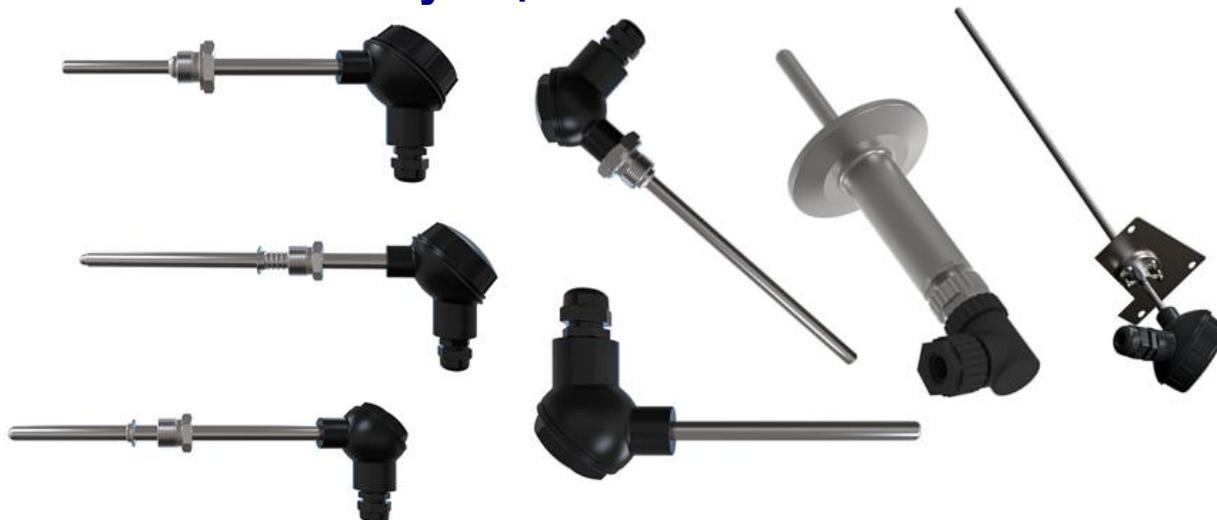
**ДТСхх5 с коммутационной головкой** позволяют измерять температуру до 500 °С (ДТС с платиновым ЧЭ) и до 180 °С (ДТС с медным ЧЭ). Подключение к измерительной линии производится медным кабелем (кабель в комплекте не идет, заказывается отдельно).
