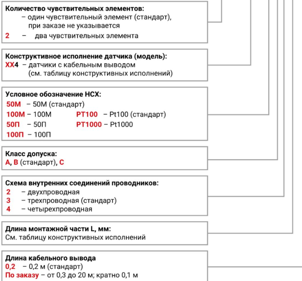
**Пример обозначения при заказе: ДТС054-50М.В3.60/1**
