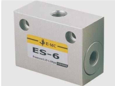
Логический клапан предназначен для управления воздушным потоком. Давление на выходе может быть получено при условии, что на любой из двух входов будет подан воздух. Если на входы поданы потоки с разным давлением, на выходе будет получен воздушный поток из входа с более высоким поданным давлением.
