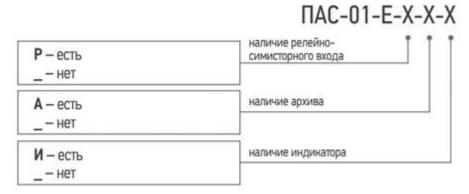
Пример записи прибора при заказе:
