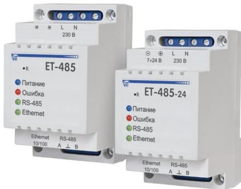
**ET-485 является микропроцессорным устройством**, предназначен для обмена данными через сеть Ethernet 10BASE-T и 100BASE-T с оборудованием, оснащенным интерфейсом RS-485 и образующим сеть Modbus.
