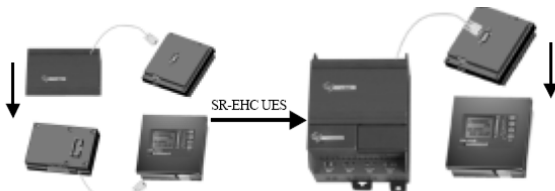
Кабель для выноса панели SR-HMI, SR-EHC.
