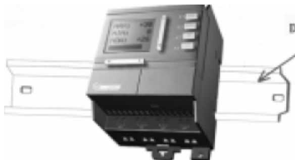
Рис. 2.1 Установка контроллера SR на стандартную DIN-рейку.
