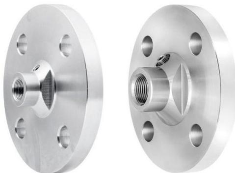
**Тип РМ.** Предназначены для защиты приборов от контакта с агрессивными, несущими взвешенные частицы измеряемыми средами путем передачи давления к прибору через разделительную мембрану и нейтральную жидкость.
