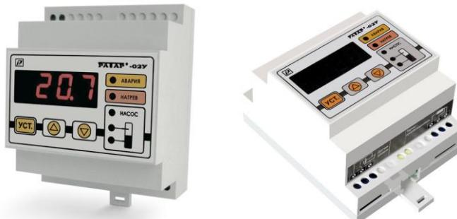
**Терморегулятор Ратар-02У** предназначен для автоматического поддержания температуры и заданного уровня в водонагревателях, отопительных котлах, системах горячего водоснабжения и отопления путём управления нагревателем и насосом.
