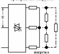
Іреле=Рнагр/(U х 1,732) Рнагр=27кВт, U=380В Іреле=27000/(380 х 1,732)=41,02А С учетом запаса по току выбираем реле на 60А.
