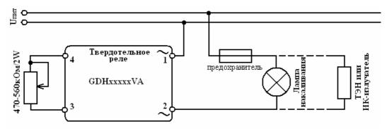
Соблюдая определенный ряд условий твердотельные реле можно использовать для пуска асинхронных двигателей. Необходимо учитывать пусковые токи двигателя и реле подбирать с многократным запасом по току. Применять меры по дополнительному отводу тепла. Для защиты реле от кратковременных перенапряжений использовать варисторы, а для защиты от перегрузки по току быстродействующие предохранители.
