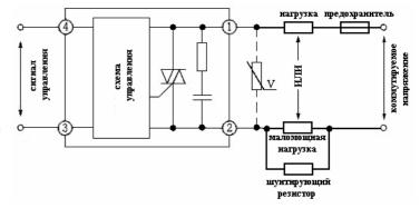
• Для корректной работы твердотельного реле на маленькие токи нагрузки необходимо устанавливать шунтирующее сопротивление параллельно нагрузке.
