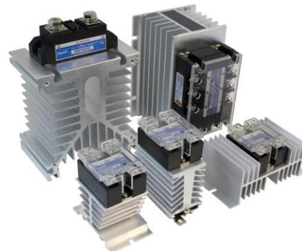
При подборе радиатора следует учитывать факторы влияющие на охлаждение, такие как: место установки, температура окружающей среды, циркуляция воздушных потоков, нагрузка на ТР. В некоторых случаях для более эффективного охлаждения (высокая температура воздуха, монтаж в закрытом шкафу и пр.) нужно применять радиатор большего размера и устанавливать вентилятор для принудительного отвода тепла.
