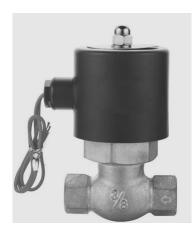
Клапан с электромагнитным управлением серии US предназначен для контроля потока рабочего тела – воды, пара или газа, находящегося под давлением. Действие клапана основано на открытии или закрытии проходного отверстия клапана в клапанной паре при помощи прямого действия на плунжер магнитного поля от электромагнитной катушки или путем усиления за счет мембраны и потока рабочего тела.
