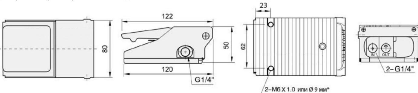
\* Имеется два варианта отверстий (резьбовое и нерезьбовое) для крепления пневмопедали.
