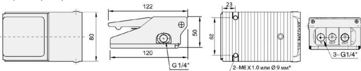
\* Имеется два варианта отверстий (резьбовое и нерезьбовое) для крепления пневмопедали.
