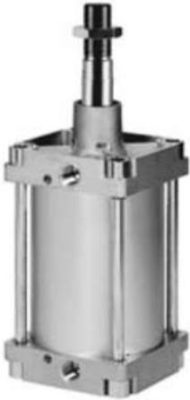
Пневмоцилиндры предназначены для преобразования энергии сжатого воздуха в механическое линейное перемещение для подъема, сдвига с силой пропорциональной диаметру рабочего цилиндра и давлению подведенного сжатого воздуха. Все поршни цилиндров могут оснащаться магнитным кольцом, которое обеспечивает возможность применения на цилиндрах бесконтактных герконовых датчиков для контроля положения поршня.
