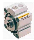
Пневмоцилиндры SD-серии относятся к серии компактных цилиндров и составляют 1/2~1/3 габаритов обычного цилиндра. Если поршень цилиндра оснащен магнитным кольцом (в маркировке присутствует литер "S") - положения поршня можно отследить с помощью герконового датчика серии HX-01R или HX-06R. Пневмоцилиндр является аналогом CQ2 фирмы "SMC".
