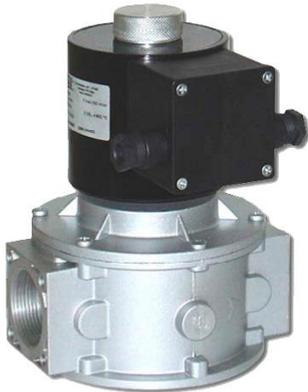
Автоматические электромагнитные клапаны **EVP/NC (EVPF)** оснащенные механическим регулятором расхода, с помощью которого возможно настроить ручную скорость подачи газа на газогорелочное устройство котла, не оснащенного автоматикой управления.
