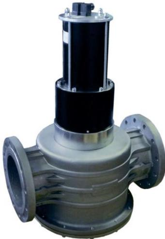
Отличительная особенность клапанов большого диаметра – это система электромагнитно-гидравлического открытия клапана, которая обеспечивает экономичный режим потребления энергии катушкой клапана в рабочем режиме.
