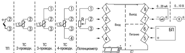
Рисунок 6.3 – Подключение прибора
