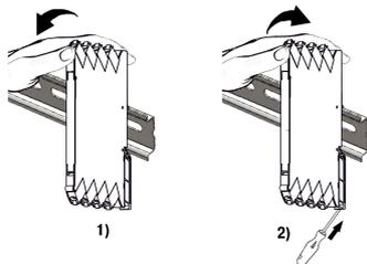
Рисунок 6.2 – Монтаж (1) и демонтаж (2) прибора
