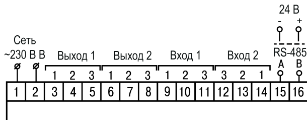
Рисунок 5.7 – Общая схема подключения ТРМ12–Н
