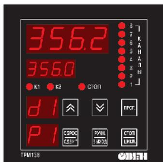
4-разрядный цифровой индикатор № 1 отображает измеренное или вычисленное значение параметра в выбранном канале контроля. При аварии индикатор отображает порядковый номер неисправного датчика. Возможны два режима индикации:
