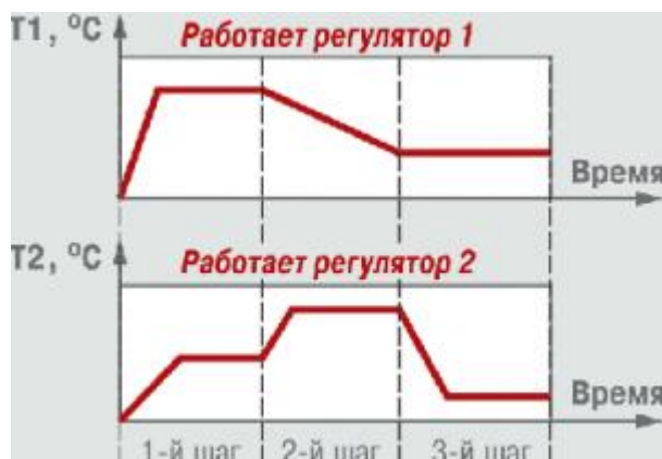
Пример программы для двухканального регулятора ТРМ151-01
