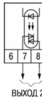
ВУ2 типа С (симисторная оптопара)
