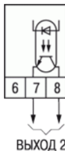
ВУ2 типа К (транзисторная оптопара)
