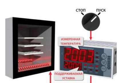
дискретный вход настроен на запуск или останов процесса автоматического управления температурой
