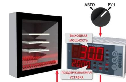
дискретный вход настроен на переход в ручной режим управления выходной мощностью
