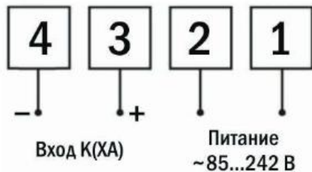
Рис. 2 – Схема подключения. Вход К(ХА)
