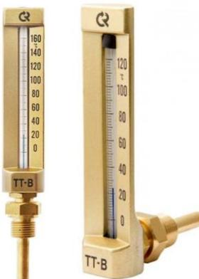
**Тип ТТ-В.** Термометр технический жидкостный предназначен для измерения температуры неагрессивных жидких и газообразных сред в пределах от  $-30$  до  $+200$  °С. Приборы могут использоваться в условиях высоких динамических нагрузок в различных отраслях промышленности.
