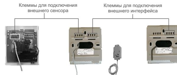
Клеммы для подключения внешнего сенсора
