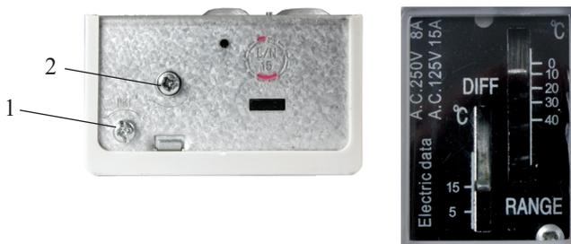
С помощью винта настройки **1** на верхней стороне прибора установите необходимое значение дифференциала, руководствуясь шкалой **DIFF** на передней панели.
