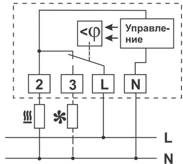
Устройства нагрева следует подключать к клеммам 2 и L, а устройства охлаждения – к клеммам 3 и L.
