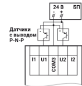
Схема подключения к универсальным входам, работающим в дискретном режиме трехпроводных дискретных датчиков, имеющих выходной транзистор р-п-р-типа с открытым коллектором
