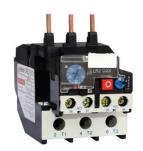
Тепловые реле серии РТЭ предназначены для защиты трехфазных асинхронных электродвигателей с короткозамкнутым ротором от токовых перегрузок недопустимой продолжительности, в том числе возникающих при выпадении одной из фаз. Реле применяются в качестве комплектующих изделий в схемах управления электроприводами в цепях переменного тока напряжением 660 В, частотой 50-60 Гц и постоянного тока напряжением 440 В.
