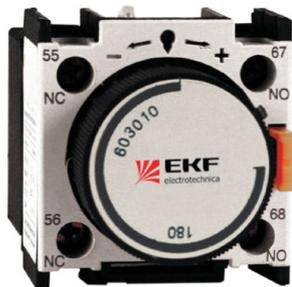
Предназначены для увеличения количества вспомогательных контактов контакторов КМЭ и КТЭ. Позволяют получить задержку замыкания или размыкания вспомогательной цепи от 0,1 до 180 сек. Приставка имеет один нормально разомкнутый (NO) и один нормально замкнутый (NC) контакт. Контактная приставка механически соединяется с контакторами и фиксируется при помощи защелки. Способ крепления обеспечивает жесткую и надежную связь между контактной приставкой и контактором.
