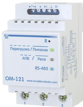
Устройство контроля электрических параметров однофазной сети. ОМ-121 предназначен для контроля напряжения, активной/реактивной/полной мощности, тока потребляемого нагрузкой и последующей передачей информации по протоколу Modbus RTU. Подключение нагрузки на клеммы прибора для измерения до 63 А.
