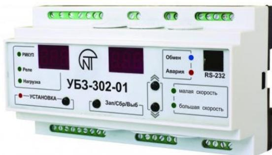
**Универсальный блок защиты асинхронных электродвигателей УБЗ-302-01** предназначен для защиты двухскоростных (двухобмоточных) двигателей, постоянного контроля параметров сетевого напряжения, действующих значений фазных/линейных токов, и проверки значения сопротивления изоляции электродвигателей.
