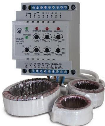
**Универсальный блок защиты электродвигателей УБЗ-301** предназначен для постоянного контроля параметров сетевого напряжения и действующих значений фазных/линейных токов трехфазного электрооборудования 380 В/50 Гц, в первую очередь, асинхронных электродвигателей (ЭД), мощностью от 2,5 кВт до 315 кВт, в том числе и в сетях с изолированной нейтралью.
